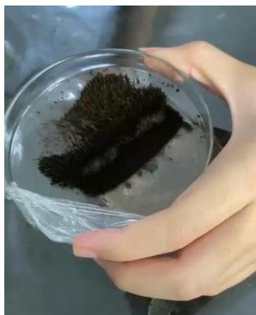
Gambar 2. Hasil Sintesis Nanopartikel Fe<sub>3</sub>O<sub>4</sub>
