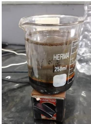
Gambar 1. Proses Pencucian dan pengendapan
