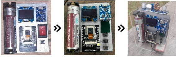
Gambar 4. Versi mesin absensi IoT
