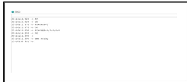
Gambar 12. Pengujian Modul GSM SIM800L
